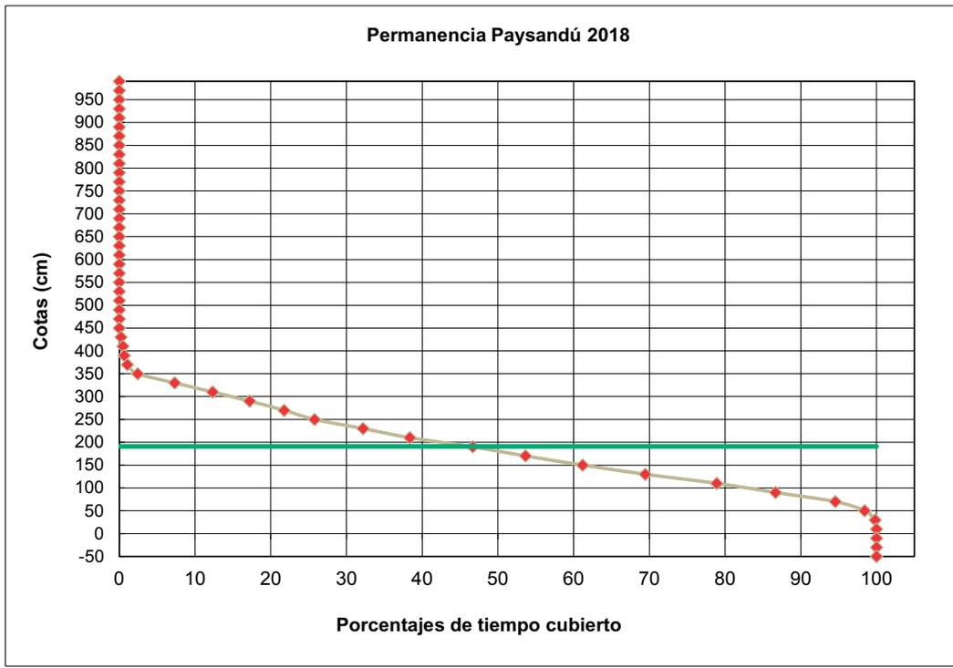
Figura 10. Curva de Permanencia para Paysandú. La línea verde indica el nivel medio (NM en centímetros) para el año 2018.
