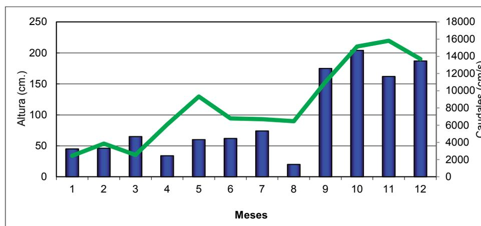
Figura 8. Mínimas alturas del agua (eje izquierdo, columnas azules) en el puerto del Paysandú, y caudales evacuados por Salto Grande (eje derecho, línea continua verde) registradas para cada mes del año 2018.
