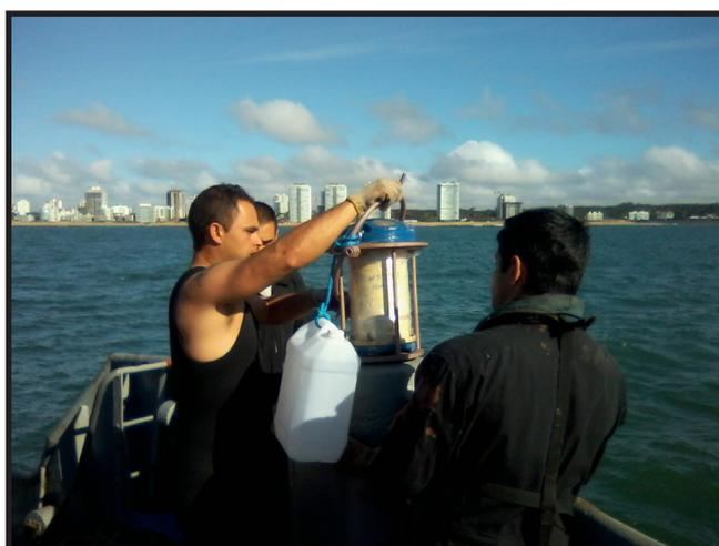
*Figura 4. Correntómetro acústico ADCP dentro del canister sujetador, listo para ser colocado en la pirámide previo a su bajada.*
