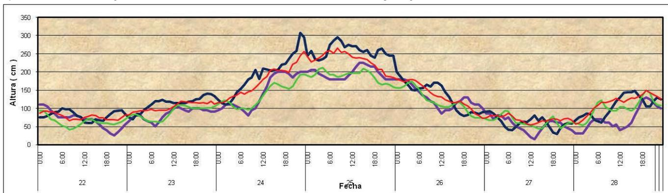
Figura 33. Altura de las aguas registradas frente a los Puertos de La Paloma (línea verde), Punta del Este (línea roja), Montevideo (línea azul) y Colonia (línea violeta) para los días 22 al 28 de Marzo del año 1998. Los valores están expresados en centímetros y referidos al cero hidrométrico provisorio (ex Wharton).
