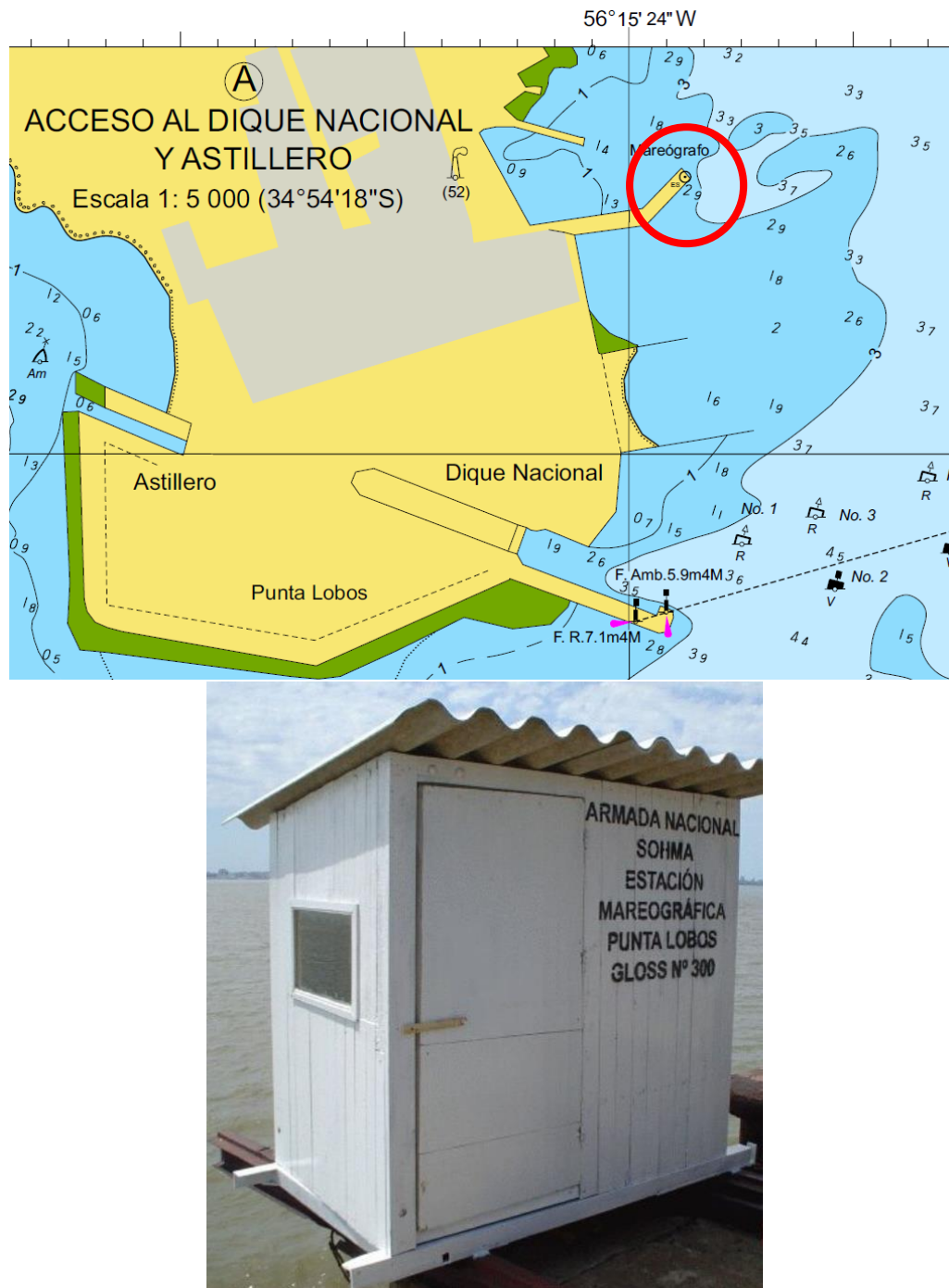
Figura 1. Arriba Indicado en círculo rojo ubicación Estación Mareográfica Montevideo (Punta Lobos) representado en el plano "A" de la carta Numero 41. Abajo Fotografía de la Casilla Mareográfica donde se encuentran los equipos registradores.
