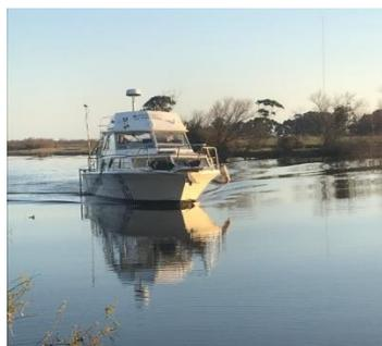
El equipamiento utilizado para el relevamiento batimétrico fue un Ecosonda Monohaz Knudsen de 200 Khz. de frecuencia, asociado a un Receptor GNSS de alta precisión con corrección diferencial activada, los cuales son operados por el Oficial Hidrógrafo a cargo a través de un computador con aplicaciones dedicadas a la planificación, adquisición y procesamiento de los datos obtenidos durante la navegación.
